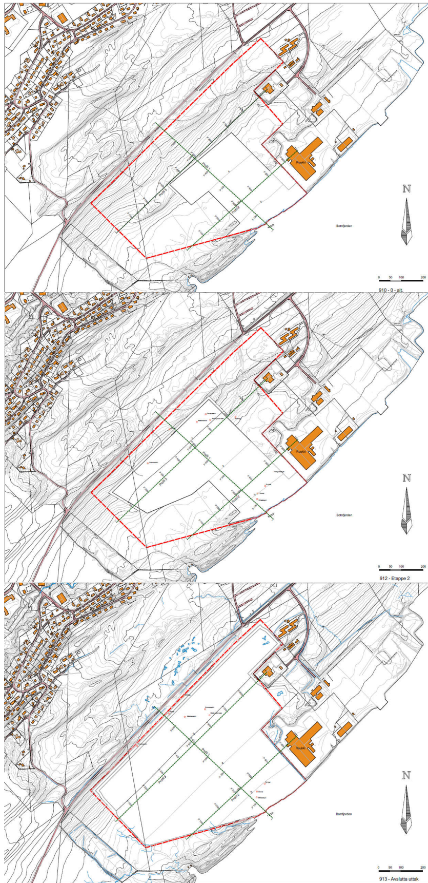
Figur 2.3. Utforming av steinbruddet for etappe 0 (øverst), 2 og ferdig uttak.
